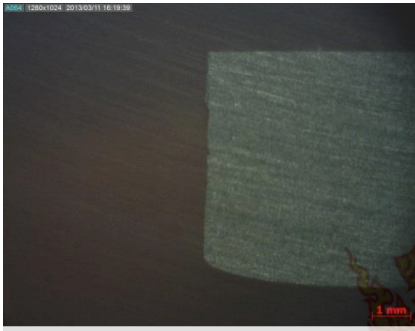
(a) ชิ้นงานทดสอบทางด้านซ้าย (b) ชิ้นงานทดสอบทางด้านขวา รูปที่ ข.37 แสดงลักษณะขอบตัดชิ้นงานทดสอบชิ้นที่สองโดยใช้ช่องว่างระหว่างคมตัดที่ 6%
