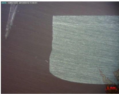
(a) ชิ้นงานทดสอบทางด้านซ้าย (b) ชิ้นงานทดสอบทางด้านขวา รูปที่ ข.53 แสดงลักษณะขอบตัดชิ้นงานทดสอบชิ้นที่สามโดยใช้ช่องว่างระหว่างคมตัดที่ 6%
