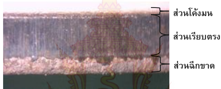
รูปที่ 14 ขอบตัดชิ้นงานที่มีระยะเคลียแรนซ์ที่น้อยเกินไป
