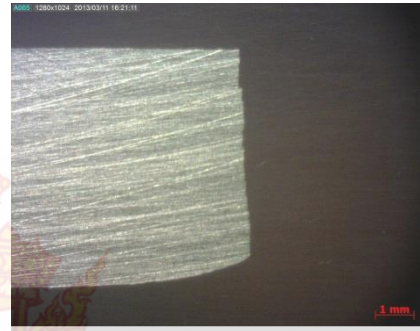
(a) ชิ้นงานทดสอบทางด้านซ้าย (b) ชิ้นงานทดสอบทางด้านขวา รูปที่ ข.37 แสดงลักษณะขอบตัดชิ้นงานทดสอบชิ้นที่สองโดยใช้ช่องว่างระหว่างคมตัดที่ 6%
