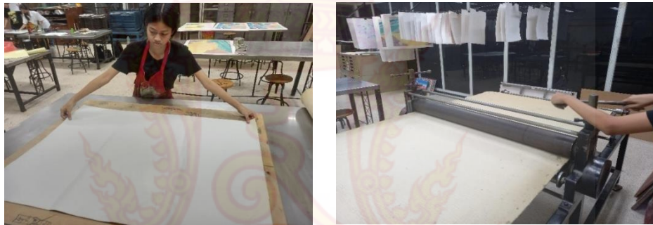
ภาพที่ 25 ขั้นตอนการนำกระดาษรูปที่ทับลงบนกระดาษฟาเบรียโน และการหมุนน้ำหนักแทนทั้งสองฝั่ง ที่มา : ข้อมูลจากผู้เขียน
