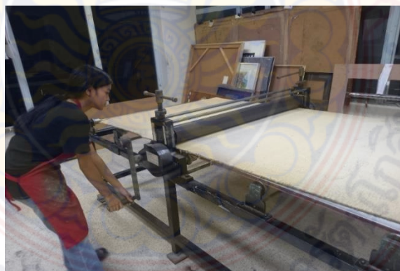
ภาพที่ 26 ขั้นตอนการหมุนแทนพิมพ์ ที่มา:ข้อมูลจากผู้เขียน
