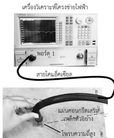
รูปที่ 4 เครื่องวิเคราะห์โครงข่าย (Network Analyzer)
