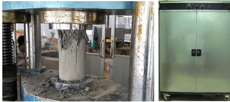
รูปที่ 3 : การทดสอบหาค่ากำลังอัดประลัยของคอนกรีตรูปทรงกระบอกเพื่อการตรวจสอบและดูข้อควบคุมอุณหภูมิอัตโนมัติ
