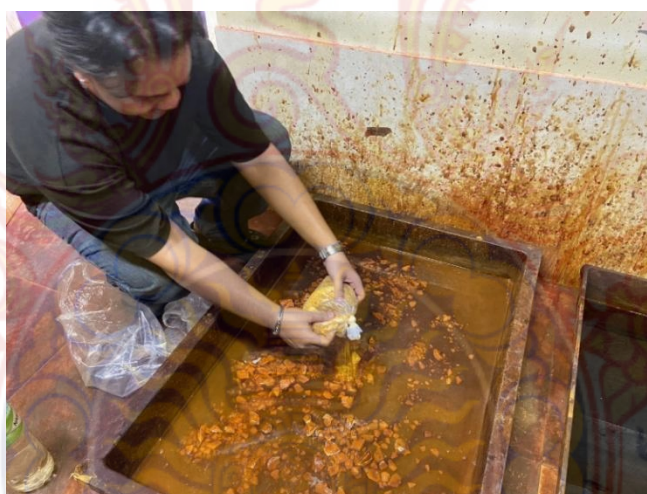
ภาพที่ 21 ขั้นตอนผสมกรดกัดทองแดง
