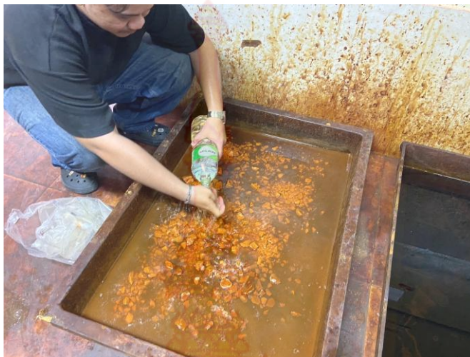
ภาพที่ 22 ขั้นตอนผสมกรดกัดทองแดง
