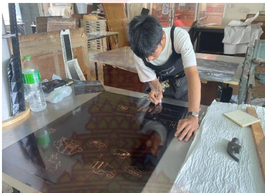
ภาพที่ 24 ขั้นตอนการคัดลอกลายลงแม่พิมพ์ด้วยเหล็กปลายแหลม
