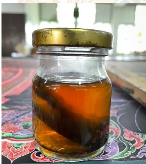
ภาพที่ 73 แสดงการใช้น้ำร้อนละลายฝักส้มป่อย และกาวกระถิน
