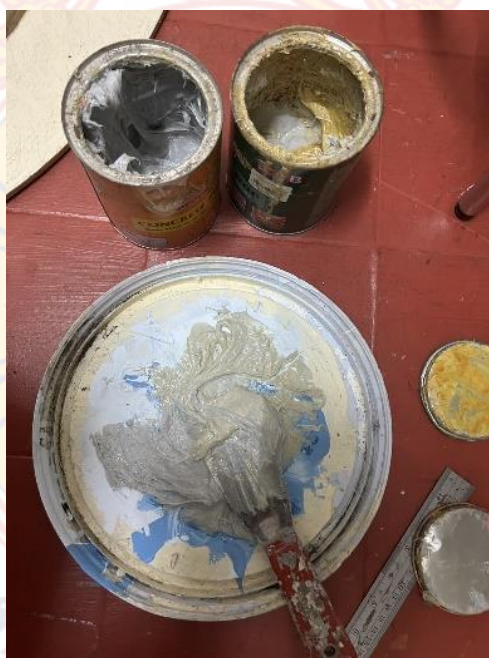
ภาพที่ 63 ภาพแสดง : ใช้น้ำยากัดสีรถและโซดาไฟผสมน้ำตามสัดส่วนที่เหมาะสมล้างให้ทั่วผลงาน เพื่อล้างไขมันและทำให้เกิดพื้นผิว
