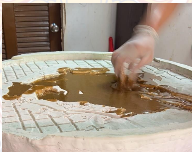
ภาพที่ 60 ภาพแสดง : ผสมเรซินกับทรายในหน้าแรกผสมตัวเร่งตามอัตราส่วนเทลงในพิมพ์ใช้แปรงเกลี่ยให้ทั่วทั้งผลงานรอให้เรซินแห้งก่อน
