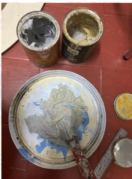
ภาพที่ 88 ภาพแสดง : เรซินผสมตัวเร่งและทรายผสมกันเพื่อนำมาอุด รู รอยต่างๆ เจียรตะเข็บ ตกแต่งให้ผลงานสมบูรณ์
