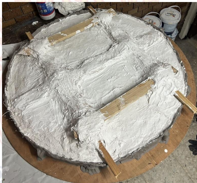
ภาพที่ 82 ภาพแสดง : พิมพ์กรอบและใช้ไม้หรือเหล็กจิ้มเป็นตารางสี่เหลี่ยมลงบนพิมพ์เพื่อสร้างความแข็งแรง
