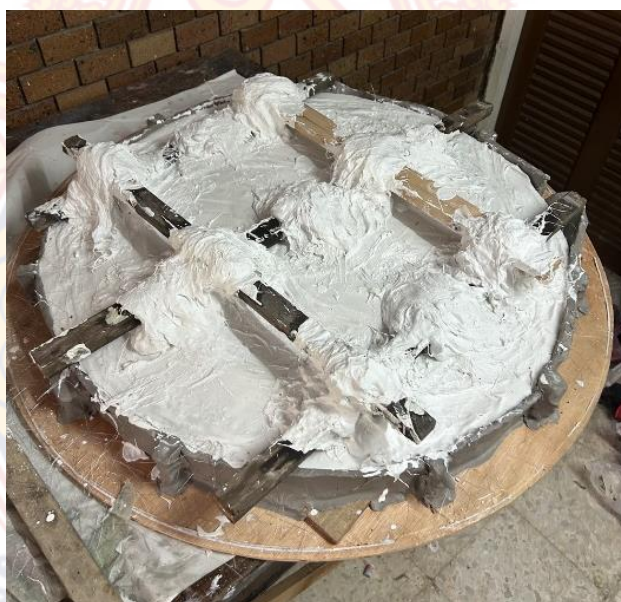
ภาพที่ 58 ภาพแสดง : พิมพ์ครอบและใช้ไม้หรือเหล็กจับเป็นตารางสี่เหลี่ยมลงบนพิมพ์เพื่อสร้างความแข็งแรง
