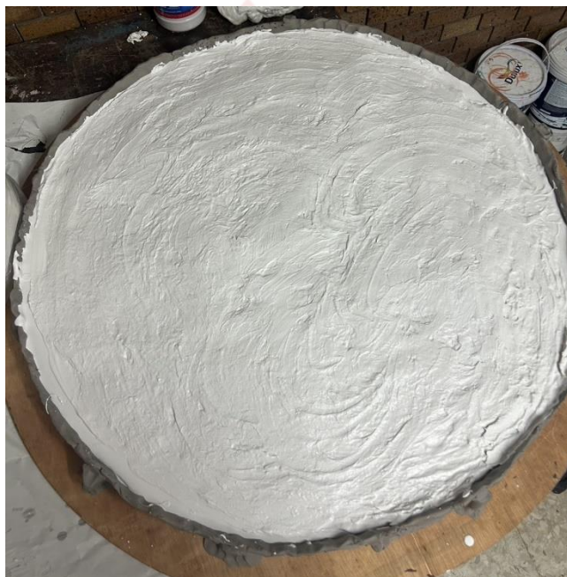
ภาพที่ 81 ภาพแสดง : นำปูนปลาสเตอร์ มาทำพิมพ์กรอบโดยการนำปูนมาผสมกับน้ำตามสัดส่วน แล้วเทลงบนชั้นยางซิลิโคน
