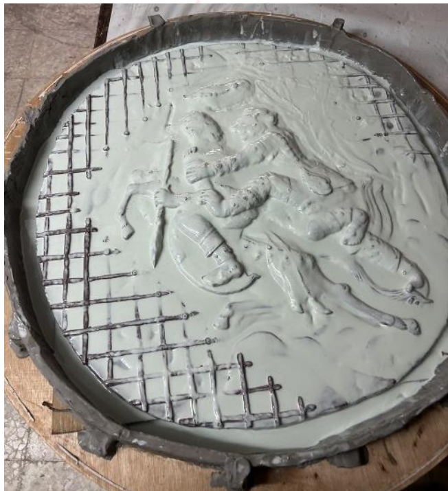
ภาพที่ 53 ภาพแสดง : นำยางซิลิโคนมาผสมตัวเร่งตามอัตราส่วนแล้วคนให้เข้ากันเทลงบนผลงานใช้นิ้วหรือแปรงทำให้ทั่วผลงานรอให้ยางที่เทลงไปแห้ง
