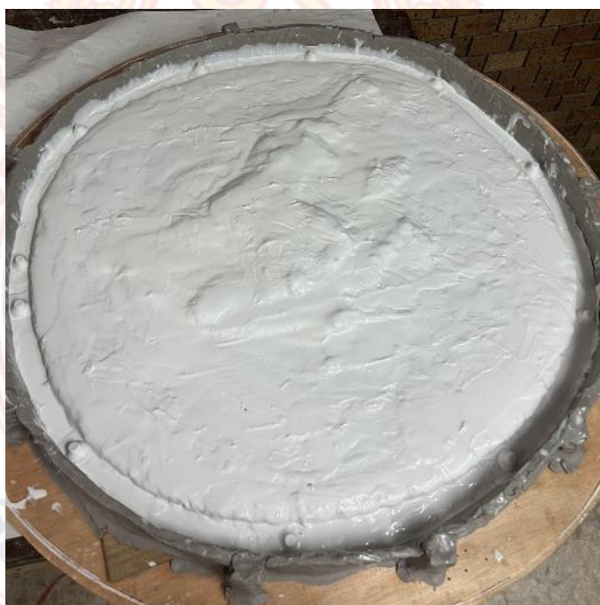
ภาพที่ 56 ภาพแสดง : เมื่อยางแห้งให้ทำอีกครั้งหนึ่ง เท่ากับได้ความหนาของยางซิลิโคนและผ้าก๊อตรองจนยางแห้ง และใส่ที่ลือกพิมพ์
