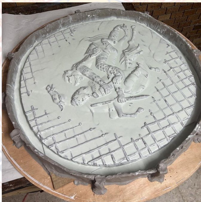
ภาพที่ 54 ภาพแสดง : ทำแบบเดิม เทยางซิลิโคนอีกหนึ่งชั้นและรอให้ยางชั้นที่ 2 แห้ง
