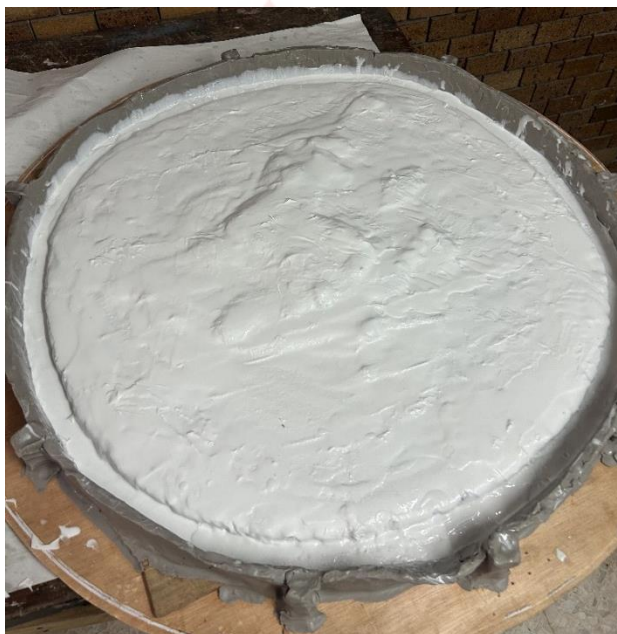
ภาพที่ 55 ภาพแสดง : ทางยางซิลิโคนลงไปให้ทั่วเป็นชั้นที่ 3 แล้วนำผ้าก๊อตหรือผ้ามุ้งตัดเป็นสี่เหลี่ยมขนาดตามความเหมาะสมวางลงให้เต็มพื้นที่โดยการใช้แปรงซับทินเนอร์เล็กน้อย ซับให้ทั่วผ้าก๊อตกับยางจะแนบเป็นเนื้อเดียวกัน
