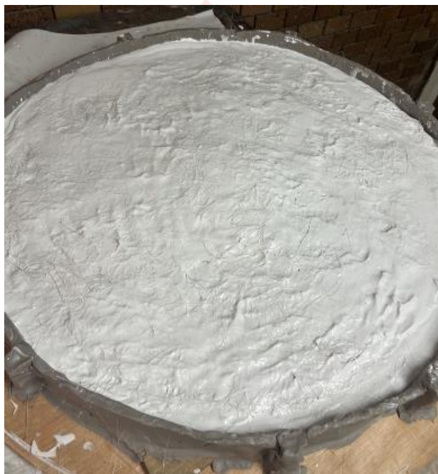
ภาพที่ 57 ภาพแสดง : นำปูนปลาสเตอร์ มาทำพิมพ์ครอบโดยการนำปูนมาผสมกับน้ำตามสัดส่วน แล้วเทลงบนชั้นยางซิลิโคน
