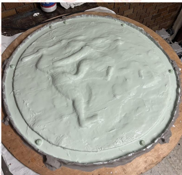
ภาพที่ 80 ภาพแสดง : เมื่อยางแห้งให้ทำอีกครั้งหนึ่ง เท่ากับได้ความหนาของยางซิลิโคนและผ้าก๊อตรองจนยางแห้ง และใส่ที่ล็อกพิมพ์
