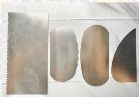
ภาพที่ 22 ภาพแสดง : แผ่นสแตนเลส ใช้สำหรับเกลี่ยหน้าดินให้เรียบ
