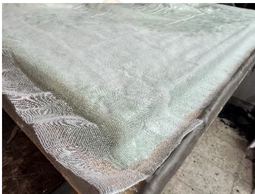
ภาพที่ 41 ภาพแสดง : ติดผ้าก๊อชให้ทั่วกับต้นแบบ
