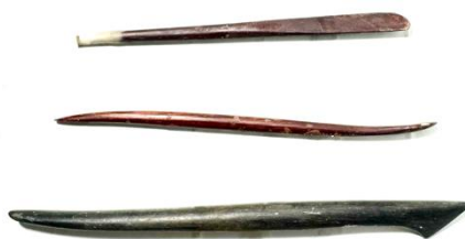
ภาพที่ 21 ภาพแสดง : เครื่องมือปั้นไม้เสียด ใช้สำหรับปาด เกี่ยและบากลาย
