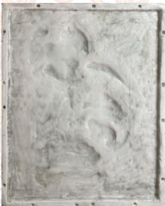
ภาพที่ 51 ภาพแสดง : พิมพ์กรอบไฟเบอร์กลาสที่เสร็จสมบูรณ์
