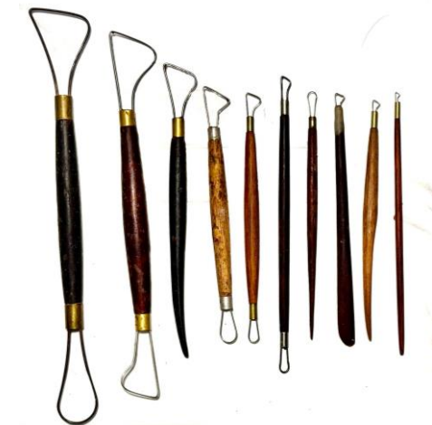
ภาพที่ 20 ภาพแสดง : เครื่องมือปั้นขนาดต่าง ๆ ใช้สำหรับขูด ควัก
