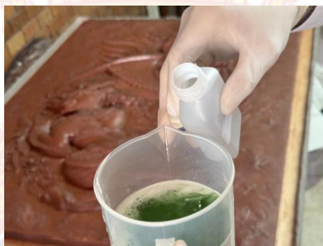
ภาพที่ 36 ภาพแสดง : สีฝุ่นผสมกับยางซิลิโคนและผสมตัวทำแข็ง 5% คนให้เข้ากัน
