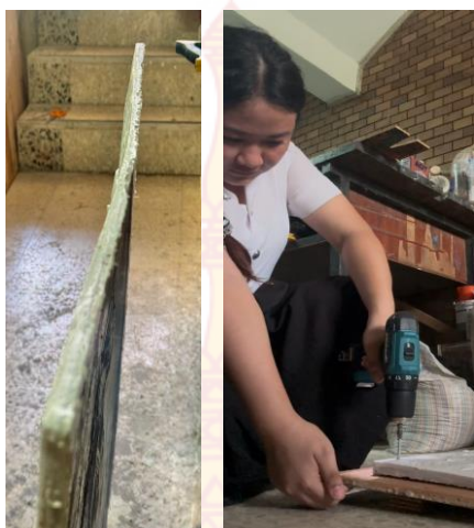
ภาพที่ 58 ภาพแสดง : การแก้ไขงานหล่อ เกิดการดุ้งของแผ่นงาน แก้ไขโดยการนำไดร์ร่อนมาเป่าแล้ว นำแผ่นงานไปวางลงบนแผ่นไม้ จากนั้นใช้ตะปูเกลียวร้อยยึดกับแผ่นไม้
