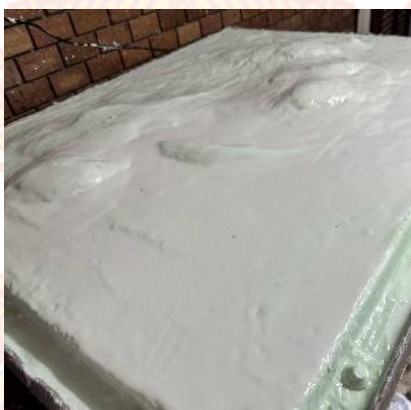
ภาพที่ 45 ภาพแสดง : เทเรซินลงพิมพ์ให้ทั่วแม่พิมพ์ยางซิลิโคน
