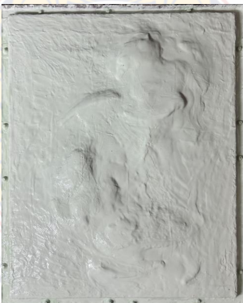
ภาพที่ 43 ภาพแสดง : ผสมยางซิลิโคนกับตัวทำแข็งรอบสุดท้าย
