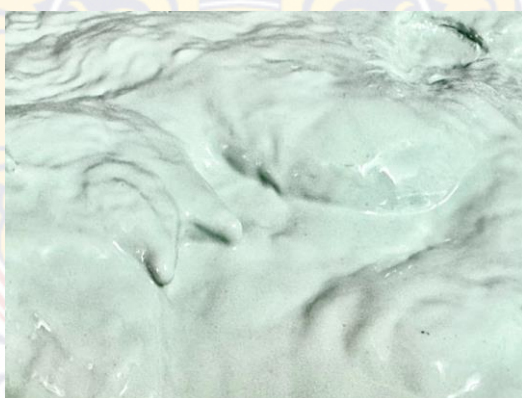
ภาพที่ 40 ภาพแสดง : ผสมยางซิลิโคนกับตัวทำแข็งรอบที่ 3 และเทยางซิลิโคนลงตรงส่วนที่ยื่นออกมา
