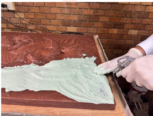
ภาพที่ 38 ภาพแสดง : การใช้หัวฉีดลม ฉีดไล่ฟองอากาศออกให้หมด
