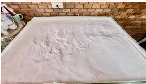
ภาพที่ 56 ภาพแสดง : เทส่วนผสมเรซินกับผงทัลคัมในชั้นสุดท้าย รोजนแห้งสนิท
