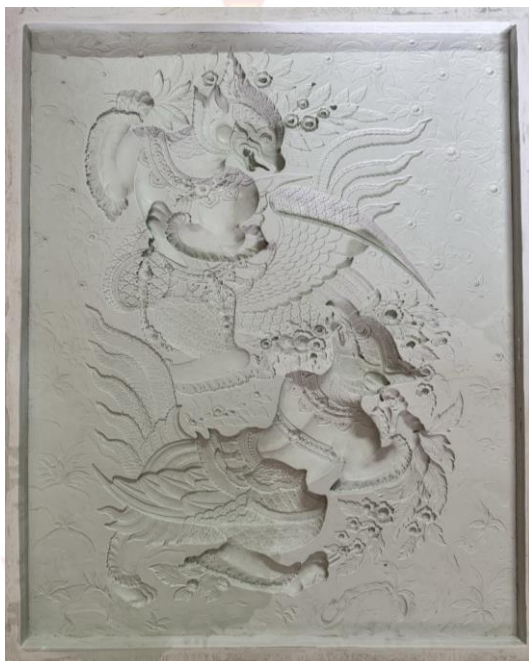
ภาพที่ 50 ภาพแสดง : แม่พิมพ์ยางซิลิโคนที่เสร็จสมบูรณ์
