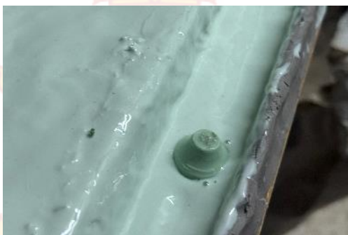
ภาพที่ 42 ภาพแสดง : วางหมุดยางซิลิโคนวางเป็นระยะ ทั้งสี่มุม
