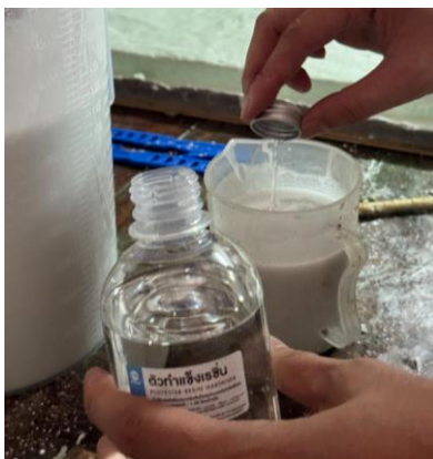
ภาพที่ 44 ภาพแสดง : ผสมเรซินกับโคบอลท์คนให้เข้ากันและนำผงทลคัมมาผสมให้เข้ากัน จากนั้นเทตัวทำแข็งในอัตราส่วน 5% ของเนื้อเรซิน ผสมให้เข้ากัน
