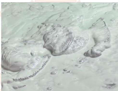
ภาพที่ 39 ภาพแสดง : ผสมยางซิลิโคนกับตัวทำแข็งรอบที่ 2 ใช้หัวฉีดลมไล่ฟองอากาศ
