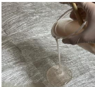
ภาพที่ 47 ภาพแสดง : ผสมเรซินผสมกับตัวเร่งปฏิกิริยาและผสมกับตัวทำแข็งในอัตราส่วน 5% ของเรซิน จากนั้นใช้แปรงปาดเรซินให้ทั่วงาน
