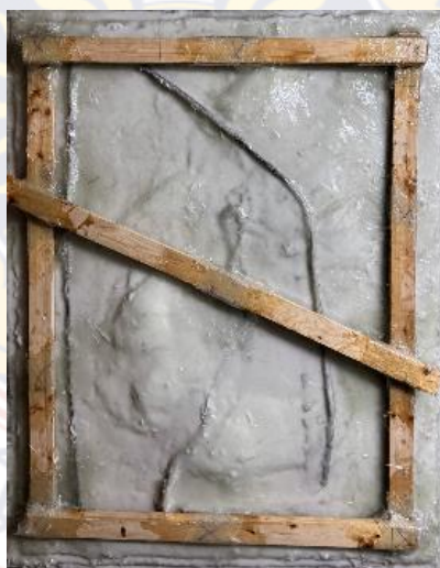
ภาพที่ 49 ภาพแสดง : การสร้างโครงยึดเกาะแม่พิมพ์ครอบด้วยไม้
