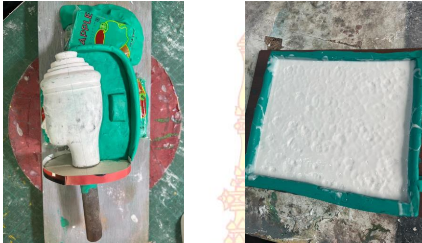
ภาพที่ 31 : การทำพิมพ์ยอดพรหมและหน้าท้าย ด้วยดินน้ำมันและยางซีลโคน ผลงานโดย : เขตนคร ด้านพิทักษ์
