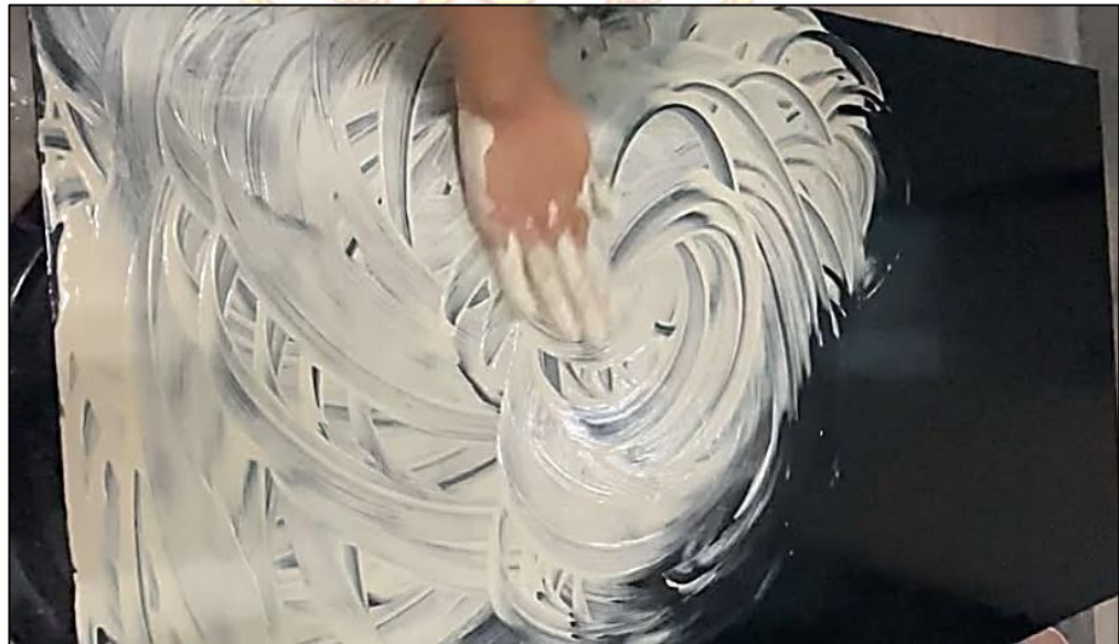
ภาพที่ 3.7 ภาพแสดง : การขัดกระดานด้วยดินสอพอง ที่มา : เกศกนก คมมูล
