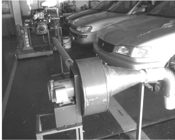
รูปที่ 1 ชุดทดลองหาค่าความเร็วต่ำสุดในการขนส่งฝุ่นซีลี้อย
