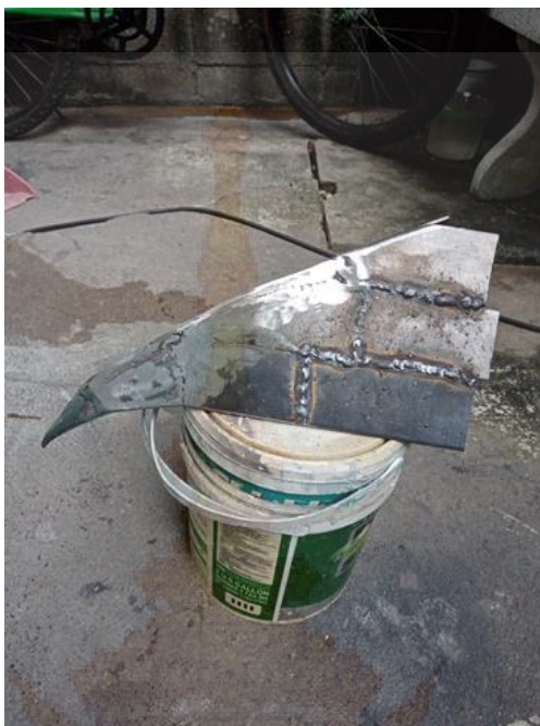
ภาพที่ ๒๖ การทำส่วนปากนกจากแผ่นโลหะและทำการขัดเจียรรอยเชื่อมออก
