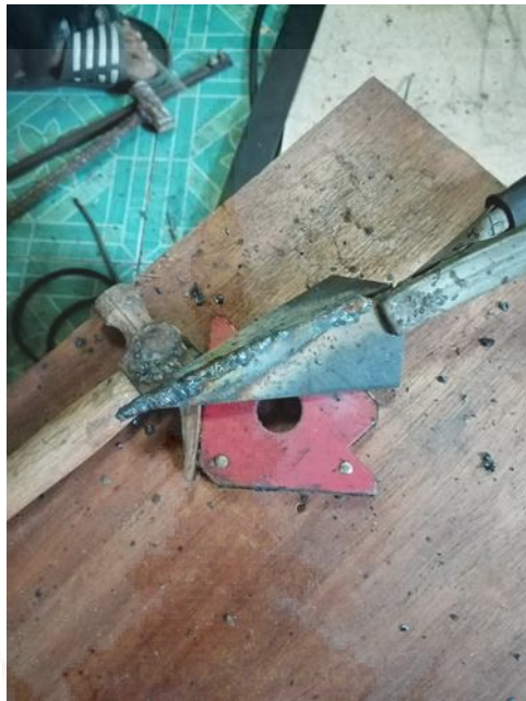
ภาพที่ ๒๔ ภาพการเชื่อมแผ่นเหล็กในส่วนที่เป็นปากของนกในงาน
