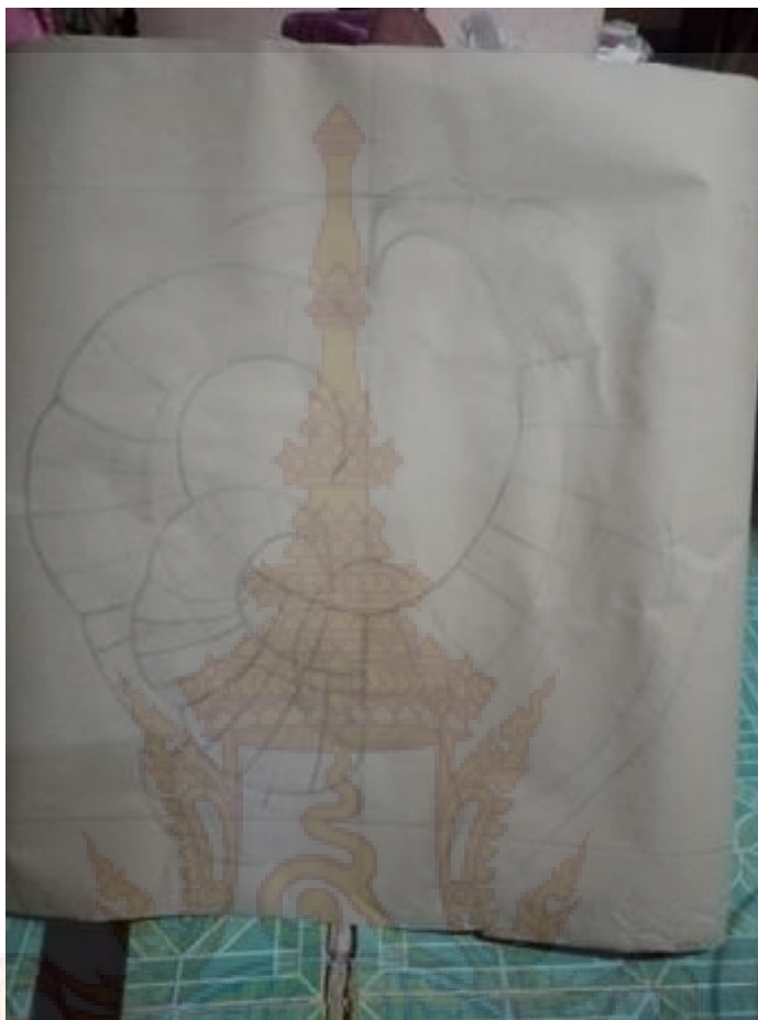
ภาพที่ ๒๐ ภาพขั้นตอนการเขียนแบบขยายงานเท่าจริง โดยวาดขยายเท่าจริงเพื่อนำมาเป็นตัวช่วยในการนำมาเป็นแบบการตัดทำโครงสร้างด้วยเหล็กเส้น
