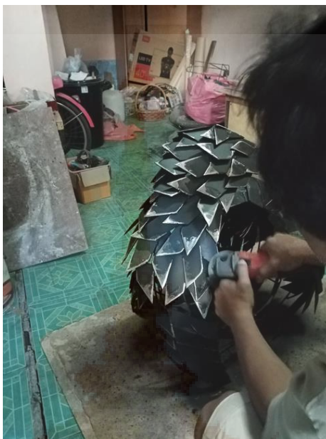
ภาพที่ ๓๐ ขั้นตอนการแต่งแผ่นเหล็กขัดรอยเชื่อมออก
