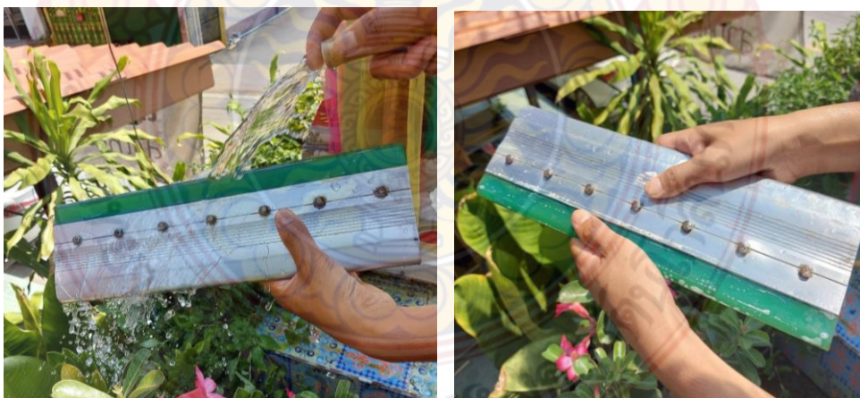
ภาพที่ 28 ขั้นตอนการล้างยางปาด ที่มา : ข้อมูลจากผู้เขียน
