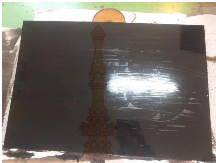
ภาพที่ 23 ทาวานิชดำเคลือบแม่พิมพ์โลหะ ที่มา: จากผู้เขียน
