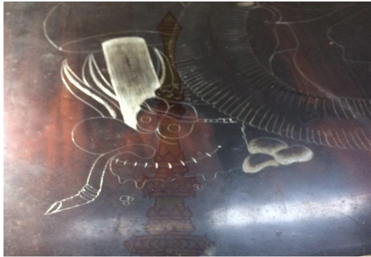
ภาพที่ 25 ใช้เหล็กแหลมขีดตามรอยเส้นที่คัดลอกลงแม่พิมพ์ ที่มา: จากผู้เขียน
