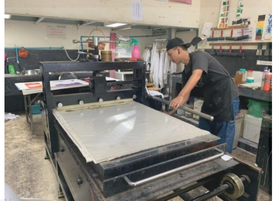
ภาพที่ 50 ดันแท่นพิมพ์เข้าจุด Start แล้วกดแกรนคั้นโยกลง ที่มา : ข้อมูลจากผู้เขียน
