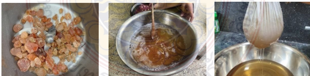
ภาพที่ 32 การเตรียมกาวกระถิน ที่มา : ข้อมูลจากผู้เขียน
