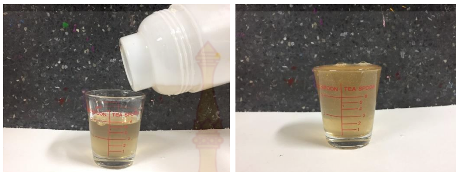
ภาพที่ 36 การผสมกาวเพื่อใช้ในการกัดกรด ที่มา : ข้อมูลจากผู้เขียน
