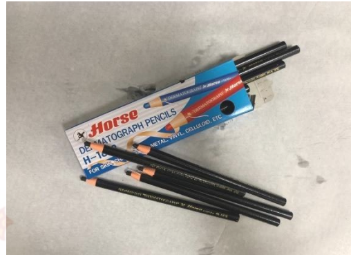
วัสดุเขียนไขแม่พิมพ์ ดินสอไขสีดำตราม้า (Horse No.1818)
