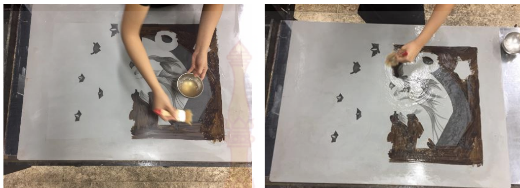
ภาพที่ 38 ขั้นตอนการกักกรด โดยใช้แปรงลูบวนสลับไป-มา ที่มา : ข้อมูลจากผู้เขียน
