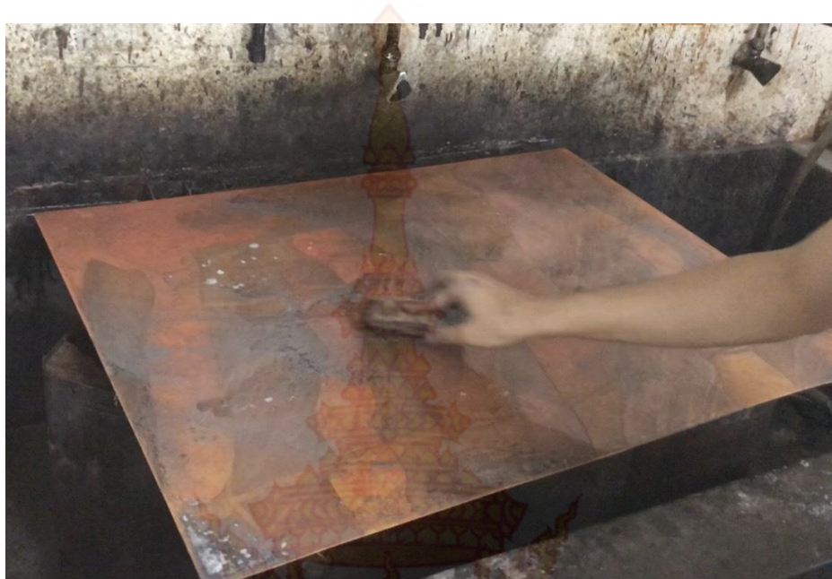
ภาพที่ 48 : ทำความสะอาดแม่พิมพ์ด้วยน้ำมันสนและทินเนอร์ ที่มา : ข้อมูลจากผู้เขียน
