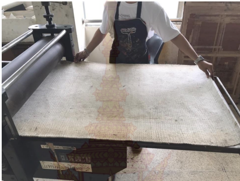
ภาพที่ 62 : วางสีกกะหลาดรองบนแม่พิมพ์ ที่มา : ข้อมูลจากผู้เขียน
