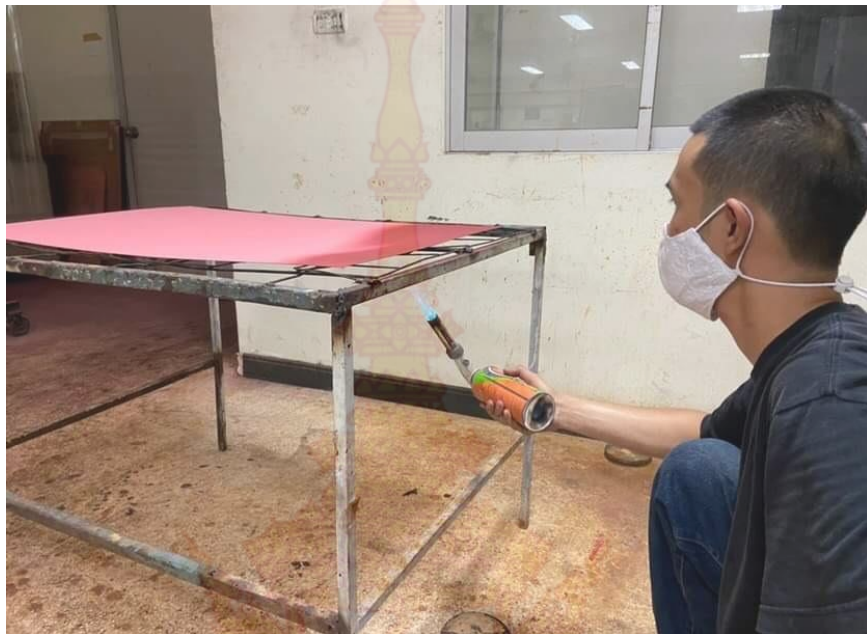
ภาพที่ 39 : ย่างแม่พิมพ์ให้สุกด้วยแก๊สเป่าไฟ ที่มา : ข้อมูลจากผู้เขียน
