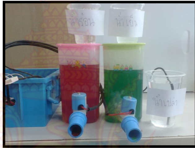
ภาพที่ 36 อุณหภูมิปกติ SOLENOID VALVE ไม่ทำงาน
