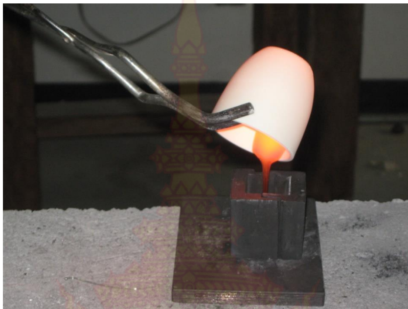
รูปที่ 3.6 เทแก้วหนืดลงในบล็อกสแตนเลสที่อบให้มีอุณหภูมิ 500 องศาเซลเซียส
