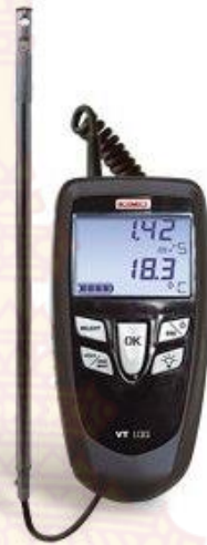
ภาพที่ 3.9 เครื่องมือวัดความเร็วอากาศเข้าเครื่องอัดอากาศ KIMO VT100
