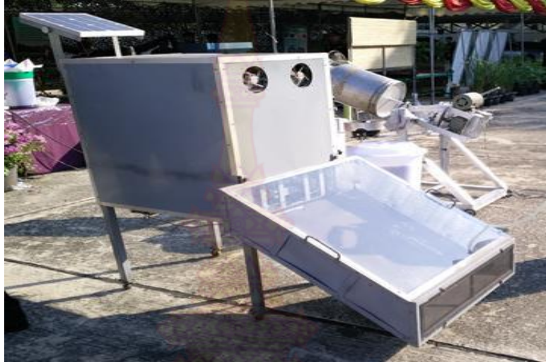
ภาพที่ 3.2 แสดงเครื่องอบแห้งพลังงานแสงอาทิตย์เมื่อประกอบเสร็จแล้ว
