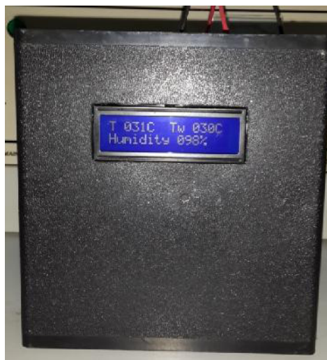
รูปที่ 4: ระบบวัดอุณหภูมิและความชื้นภายในอาคารด้วยหัววัดแบบอาร์ซีไทม์
