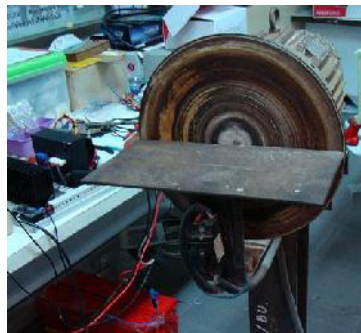
รูปที่ 10 เครื่องเจีย ขับด้วยมอเตอร์ 1 เฟส 220 โวลท์ ขนาด 1 HP
