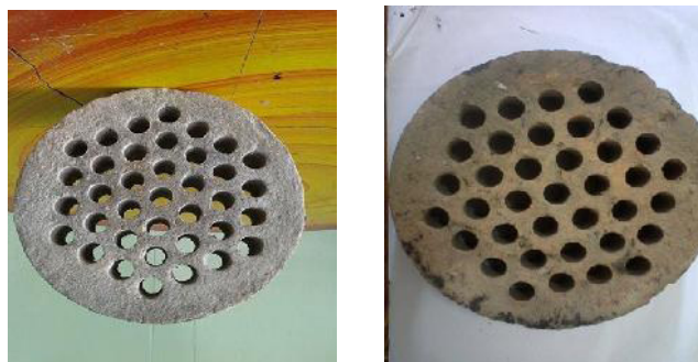
รูปที่ 1 รังผึ้งชนิดรูตรง (ซ้าย) และชนิดรูเกลียว (ขวา) ที่นำมาทดลอง
